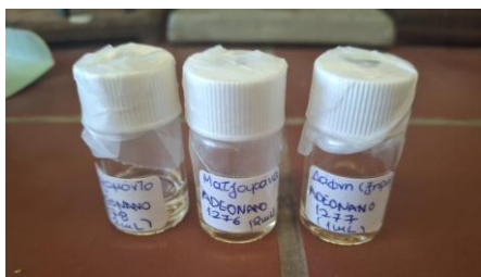
Εικόνα 6: Αιθέρια έλαια που αποστάχθηκαν με συσκευή Clevenger.
